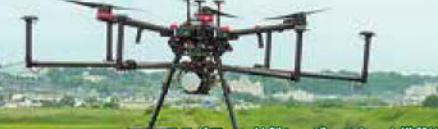
テラドローン社製レーザースキャナ搭載UAV
